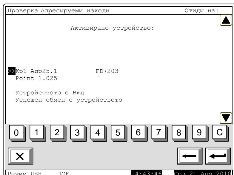
При успешен обмен с устройството изходът трябва да се задейства.
