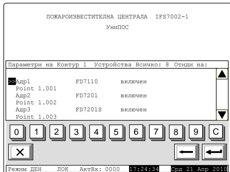
Бутоните и в дясната част на панела се извеждат при наличие на повече от едно устройство в контура, а полето „Отиди на:“ в дясната част на заглавния ред на панела и бутоните с цифри се извеждат при наличие на повече от три устройство в контура.
