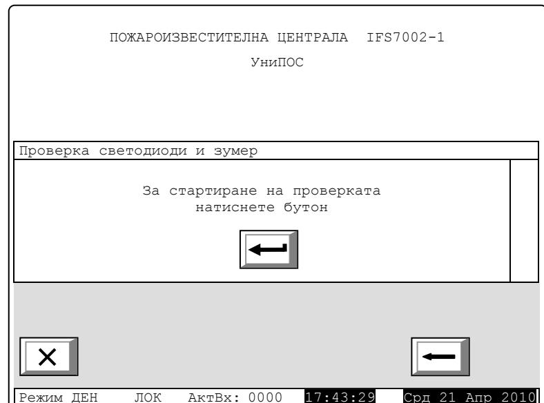
Повторното натискане на бутон изключва проверката – светодиодите и локалния звуков сигнализатор се връщат в предишното си състояние.
