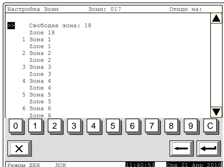
Бутоните и в дясната част на панела се извеждат при наличие на поне една зона, а полето „Отиди на:“ в дясната част на заглавния ред на панела и бутоните с цифри се извеждат при наличие на повече от 6 зони.
