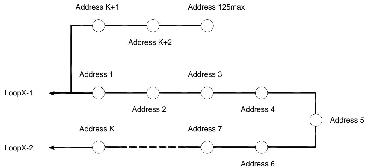
б) Неправилно свързване на разклонение на Пожароизвестителен контур
