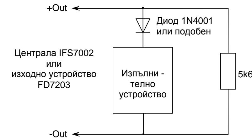
а) схема на свързване на изпълнително устройство към контролирам изход
