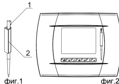
Самозалепващата подложка на носача (поз.2, фиг.1) позволява закрепване на подходящо място.
