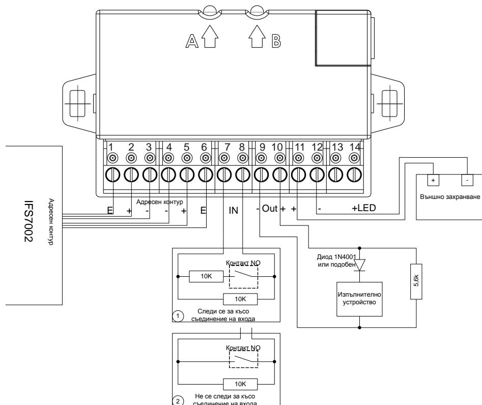
Свързване на входно-изходно устройство FD7203 (1 вход/1 изход-контролираме)
