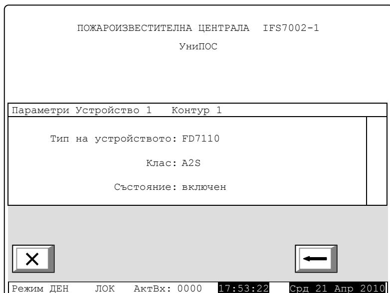
Ако имаме устройство тип FD7201 или FD7201S и желаем да работи като контролираме вход, е необходимо в Настройка / Контур / Контур X / Параметри на устройството за типа на FD7201, че е Контролираме вход както е показано:
