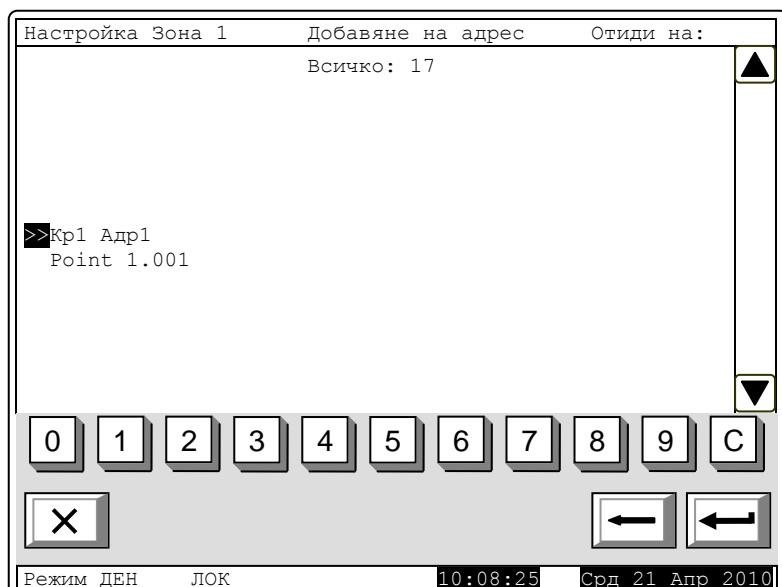
Бутоните и в дясната част на панела, полето „Отиди на:“ в дясната част на заглавния ред на панела и бутоните с цифри се извеждат при наличие на повече от едно свободно устройство.
