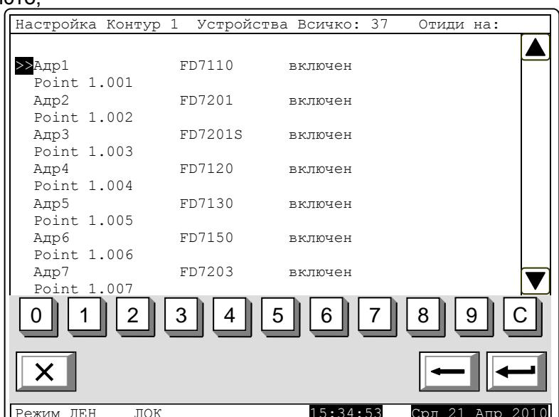
Бутоните и в дясната част на панела се извеждат при наличие на повече от едно устройство в контура, а полето „Отиди на:” в дясната част на заглавния ред на панела и бутоните с цифри се извеждат при наличие на повече от 7 устройства в контура.
