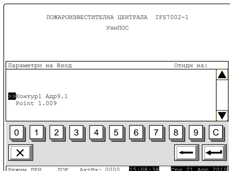
Устройствата са номерирани в следния ред: първо устройство от Контур1 до последно устройство от Контур1, първо устройство от Контур2 (ако се управлява отдалечена централа с 2 контура) до последно устройство от Контур2.
