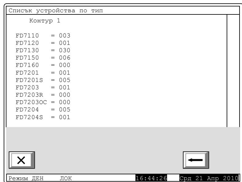
**Забележка #1:** Инициализират се само включените контури, които са в режим на автоматична адресация. Ако има включен контур в режим ръчна адресация то чистата инициализация е винаги неуспешна. За да бъде успешна е необходимо да се изключи контура, който е в режим ръчна инициализация или да се промени на автоматична инициализация.
