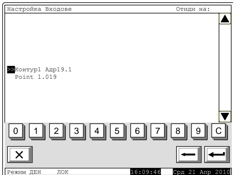
Бутоните **▼** и **▲** в дясната част на панела се извеждат при наличие на повече от един адресирами вход, а полето „Отиди на:“ в дясната част на заглавния ред на панела и бутоните с цифри се извеждат при наличие на повече от едно адресирами входни устройства.
