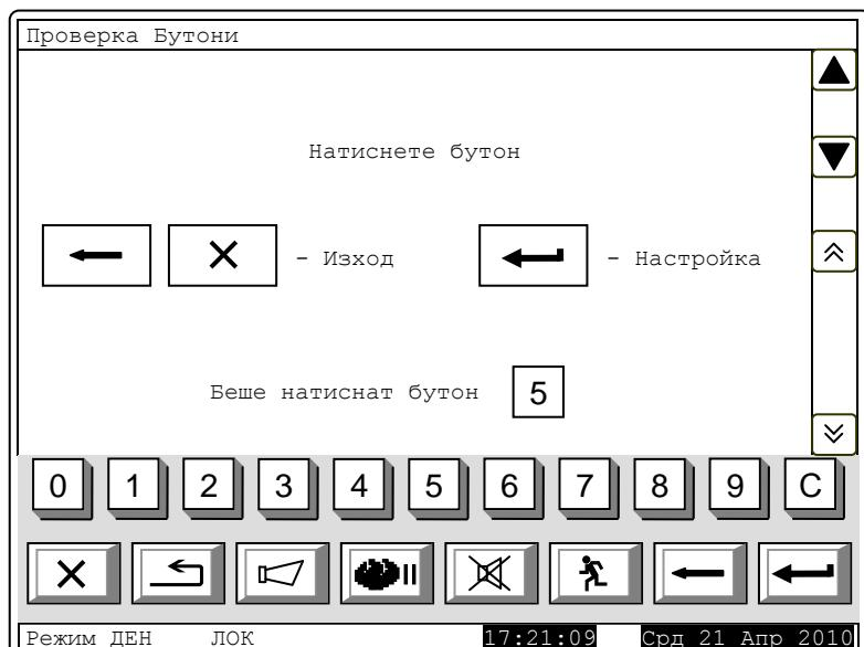
При натискане на бутон се стартира функция за настройка на бутоните. Настройката се извършва по две точки от дисплея и накрая се проверява по две. При влизане във функцията се извежда еcranът с първата точка за настройка:
