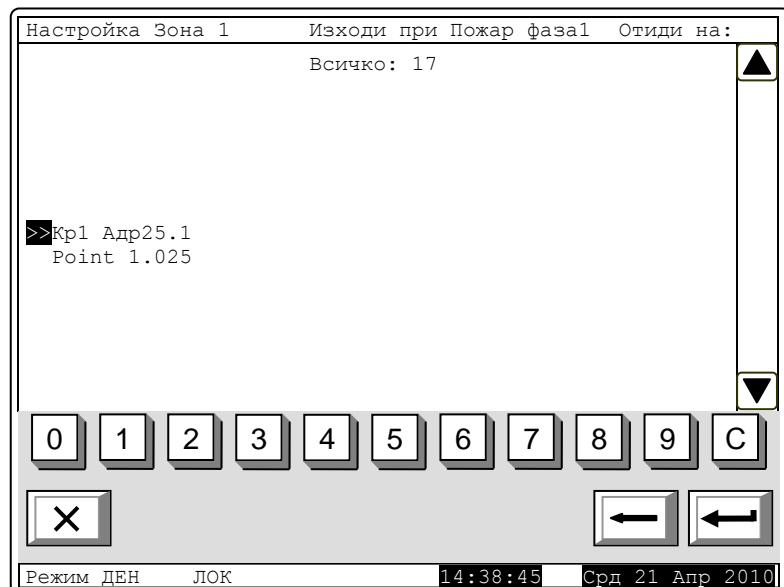
Бутоните и в дясната част на панела се извеждат при наличие на повече от един свободен адресирам изход, а полето „Отиди на:“ в дясната част на заглавния ред на панела и бутоните с цифри се извеждат при наличие на свободни адресирани изходи от повече от едно устройство.
