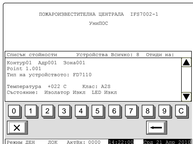
При натискане на бутон с цифра се показва бутон и се активира полето „Отиди на:“, където може да се въведе произволен 3-цифрен номер на устройство. Коригирането на този номер става с бутон , при натискането на който се изтрива последната въведена цифра.
