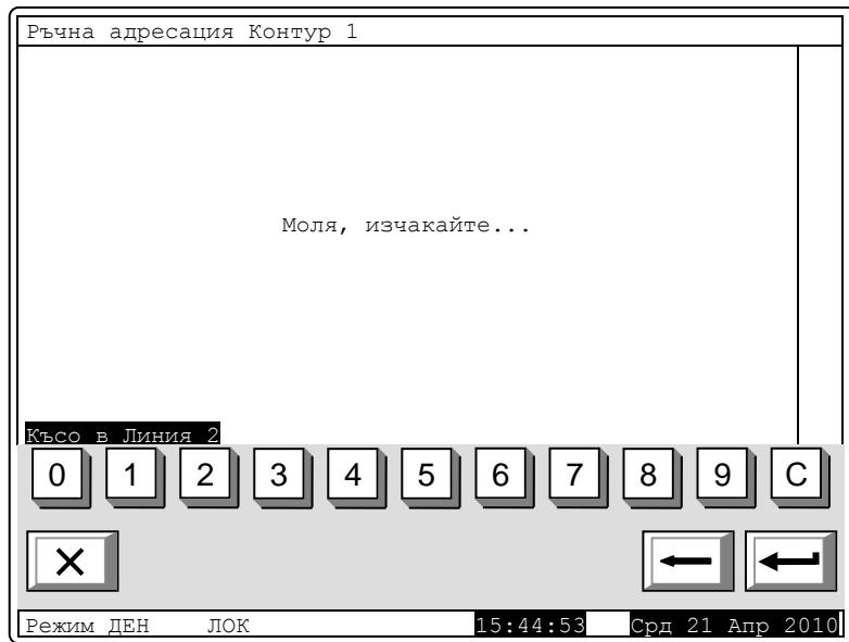
4. Проверява за наличие на блокирани устройства. По време на тази проверка в долния десен ъгъл на панела на
