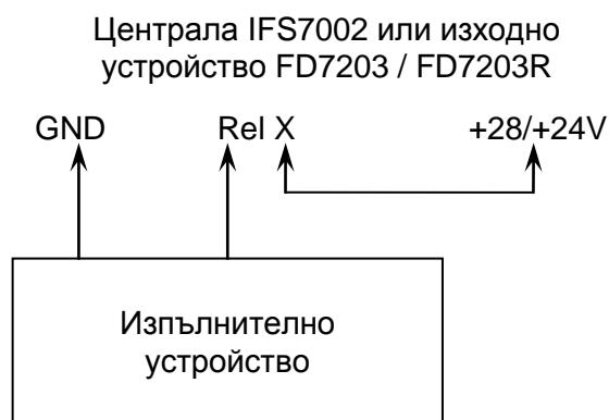
б) схема на свързване на изпълнително устройство към релеен изход
