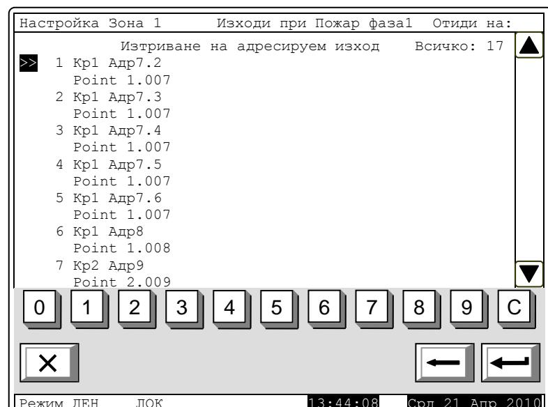
Бутоните и в дясната част на панела се извеждат при наличие на повече от един изход, а полето „Отиди на:“ в дясната част на заглавния ред на панела и бутоните с цифри се извеждат при наличие на повече от 7 изхода, асоциирани към зоната.
