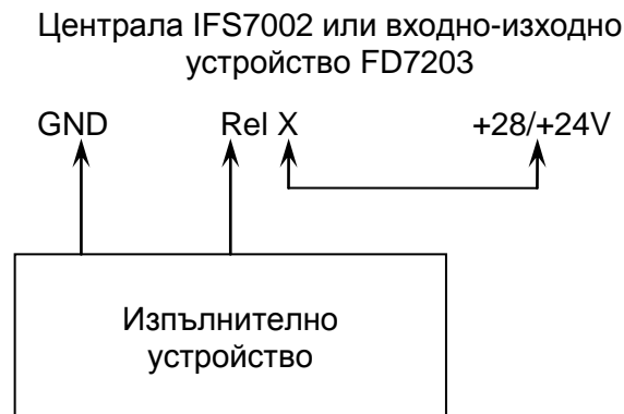
б) схема на свързване на изпълнително устройство към релейен изход
