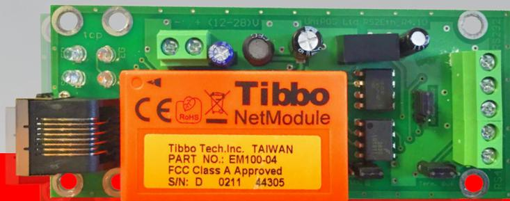
Le module d'interface RS-LAN est un dispositif optionnel pour la communication réseau des centrales de détection incendie fabriqué par UniPOS, avec un ordinateur via un réseau Ethernet (LAN ou Internet).
