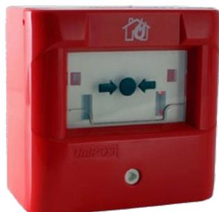
Il pulsante di allarme manuale **FD3050** è progettato per inviare un segnale di allarme alla centrale di controllo in caso di presenza di un incendio. Il dispositivo viene attivato manualmente dall'operatore mediante la pressione del vetrino.
