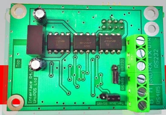
Le module d'interface RS232/485 est entièrement compatible avec les centrales incendie conventionnelles FS5100 et FS5200 d'UniPOS. Ils peuvent être utilisés pour des interconnexions avec un PC et pour l'intégration d'un répéteur de réseau conventionnel.
