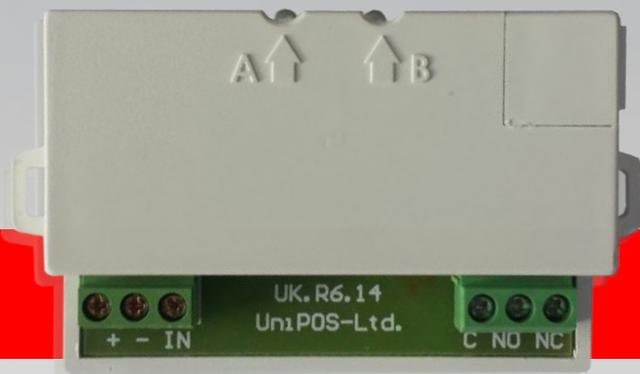
Les modules de relais de fin de ligne se connectent aux sorties des centrales de détection d'incendie et sont prévus pour le contrôle de toutes les unités fonctionnelles d'enclenchement.
